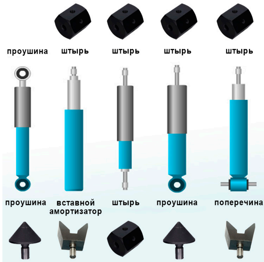
Рисунок 18. Типы креплений амортизаторов и сочетание приспособлений для их монтажа на стенде
